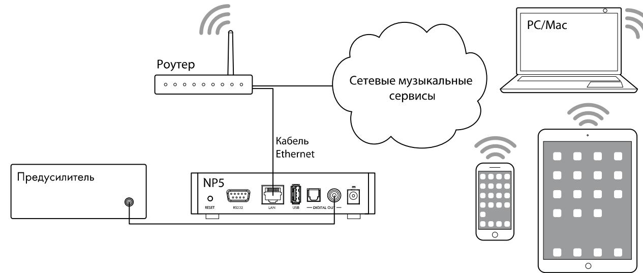
NP5 Prisma может использовать Chromecast для прямого подключения к любому поддерживаемому музыкальному сервису, например, Spotify, Deezer, Tidal или TuneIn Radio. Музыка транслируется прямо на NP5 Prisma. После настройки вы можете использовать телефон как для совершения звонков, так и для воспроизведения аудио.
